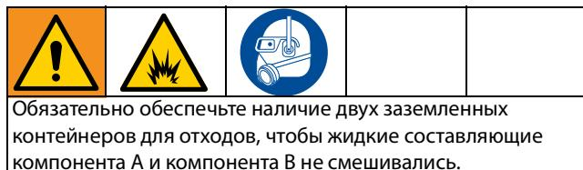
Обязательно обеспечьте наличие двух заземленных контейнеров для отходов, чтобы жидкие составляющие компонента A и компонента B не смешивались.
